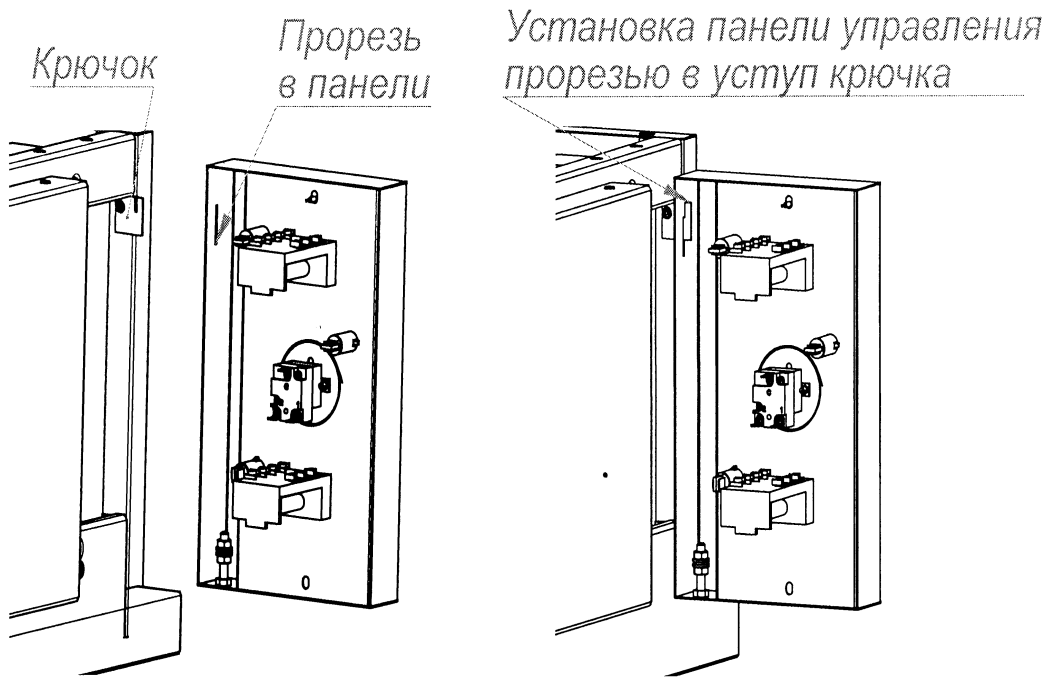
Рис. 7. Технологическое окно для замены контрпетли.
